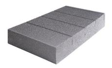
Pannello isolante detensionato a densità maggiorata e a basso assorbimento d'acqua idonea per l'isolamento a cappotto della zoccolatura perimetrale, realizzato in polistirene espanso EPS additivato di grafite.
